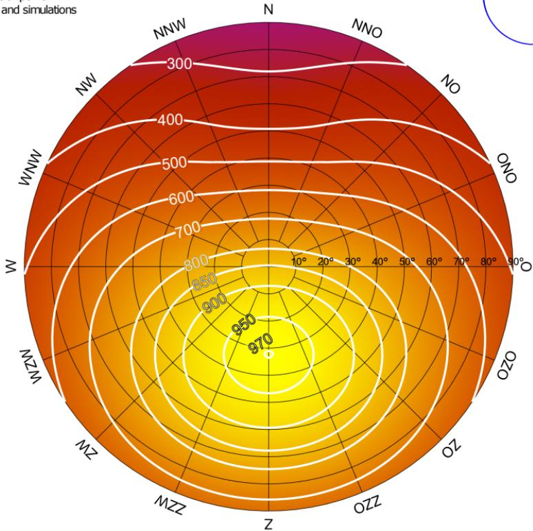
opbrengstdiagram (kWh / kWp)
